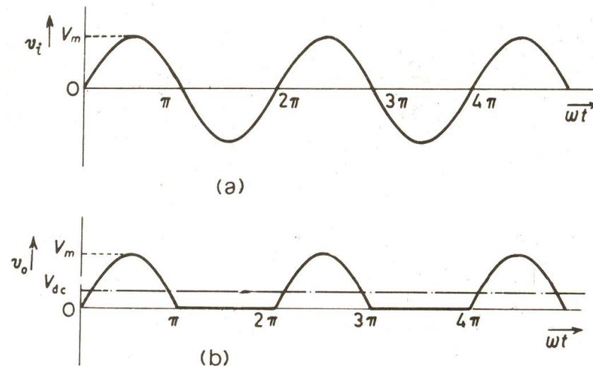
Half-wave rectifier: (a) Input voltage waveform
