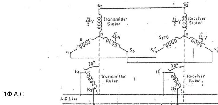
FOLLOW UP SYSTEM OF SYNCHRO TRANSMITTER AND RECEIVER
