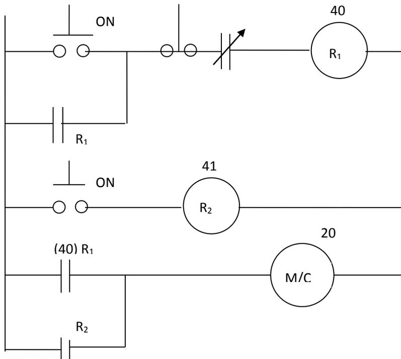
**MECHANICAL LOGIC USING PLC****LOGIC:**
